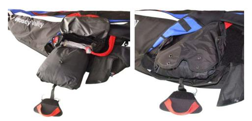
Infilare un cordino sottile (1 o 2 mm di diametro) in ciascuna asola elastica, con l'aiuto dei quali riuscirete a chiudere il contenitore. Infilare le asole elastiche nei due occhielli più piccoli che meglio rispetto le dimensioni del vostro paracadute di soccorso. Seguire l'ordine di chiusura dei vari lembi visibile nei disegni/foto sottostanti.
